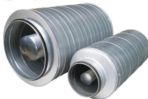
**OPTIMUM 100XL** Silencieux grandes dimensions ( $\varnothing > 500$  mm) avec atténuateur central de type bulbe et isolant acoustique de 100 mm
