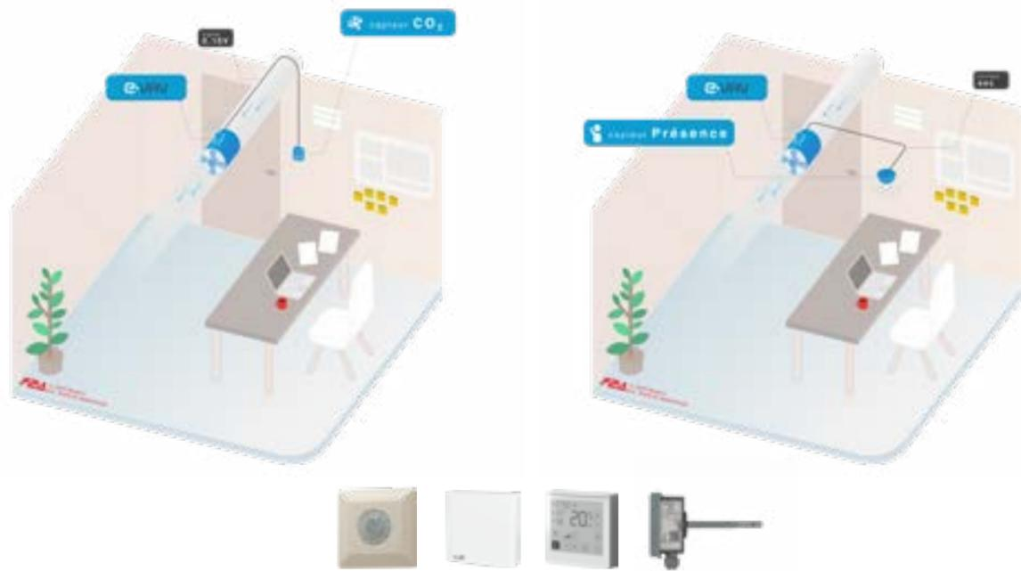
Le capteur de CO<sub>2</sub> ou le détecteur de présence sont installés dans la pièce à contrôler. Ils sont alimentés en 24V. Ils pilotent les e-VAV par un signal filaire en 0-10V ou en contact sec via le bornier RJ11 latéral. Cf notice technique pour plus d'informations
