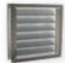
Les clapets sont des composants aérauliques conçus pour éviter le passage d'air vers une section du réseau. Ils sont composés d'un cadre et de lames (indépendantes ou non) qui obturent le conduit par gravité.
