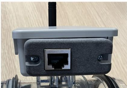
1/ Sélectionner la connexion RJ45 sur le côté latéral du boîtier électrique
