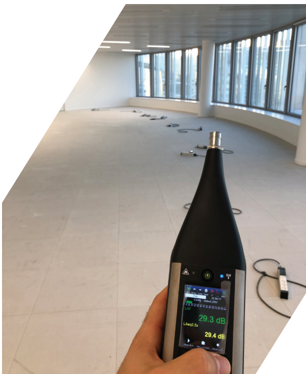
Mesures de contrôle réception de chantier
